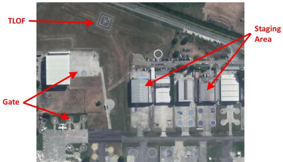
**Fig. 6.** Aeropuerto Campo de Marte displaying attributes of a “remote apron” topology.
